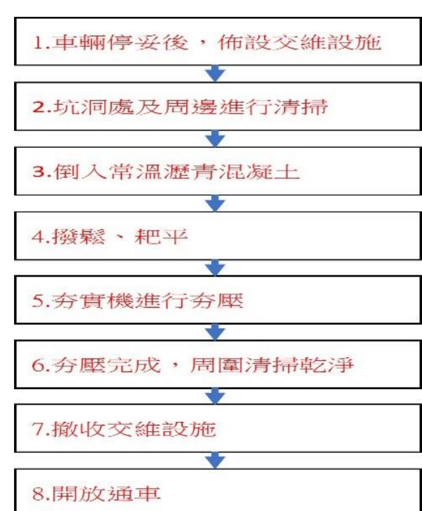
(圖3) 一般坑洞修補流程
