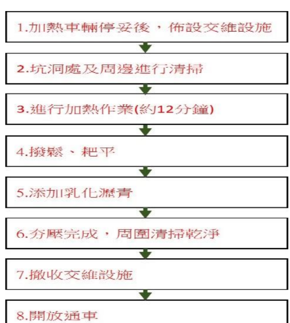
圖8 加熱型鋪面維護車施工工程流程
