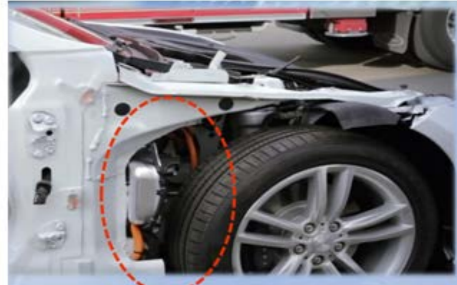
圖 4-2: 電動車輛引擎室高壓電線及組件位置。資料來源:桃園市政府消防局教官團(2020)。[5] 資料來源:方偉至(2020)。[4]
